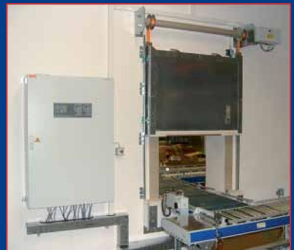
durchlaufender Gurtförderer mit 400 V Ersatzstromanlage
