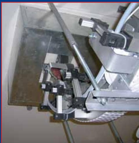
Scharnierkettenförderer durch Deckenöffnung
