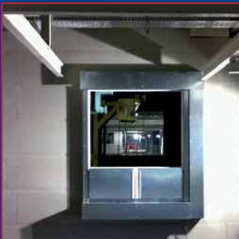
Elektrohängebahn im Heberschacht
