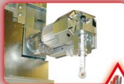
Opcional: Abertura manual y dispositivo integrado de parada de emergencia y adicionalmente dispositivo mecánico de detención.
