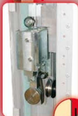
La protección anti-caída garantiza óptima seguridad en caso de defectos en las cadenas portantes o en el sistema de accionamiento
