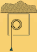
Montage du coffre directement au plafond, révision frontale ou par-dessous.
