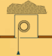
Montage du coffre directement au plafond, le faux-plafond est aligné en partie basse avec le coffre, révision par-dessous.
