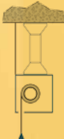
Sous-plafond avec suspentes. Révision frontale ou par-dessous.
